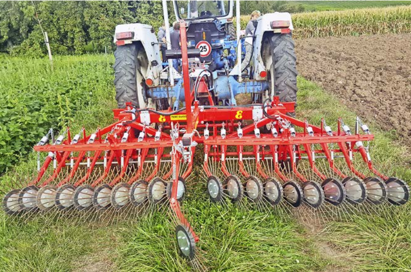
Der Rollstriegel wirkt auch in der Reihe. Bild: Nathaniel Schmid, FiBL
