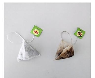
Optischer Vergleich eines frischen sowie eines Teebeutels nach 90 Tagen in einem aktiven Boden. Bild: Florian Walder Agroscope
