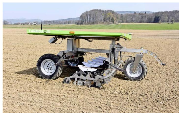
Angetrieben wird der Roboter von einem Elektromotor. Der Strom dazu liefern die integrierten Akkus. Das Gerät ist für eine Fläche von maximal zwanzig Hektaren ausgelegt. Der Farmdroid bewegt sich mit einer Geschwindigkeit von nur 0.7 Kilometer pro Stunde über den Acker, was gewöhnungsbedürftig ist. Die Arbeitsbreite beträgt drei Meter, das Gewicht nur 700 Kilogramm. Bodenverdichtungen sollte es deshalb keine geben. Bild: FiBL
